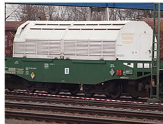
Ein CASTOR-Behälter mit radioaktivem Abfall aus der Wiederaufbereitungsanlage La Hague auf dem Weg nach Gorleben.
