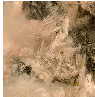
Die feinen Kristallstäbchen des Montmorillonits verleihen dem Bentonit seine Absorptions- und Quellfähigkeit.
