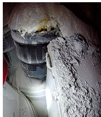
Beschädigtes Fass mit radioaktivem Müll in der WIPP: Kontaminiertes Material ist beim Platzen des Behälters ausgetreten.
