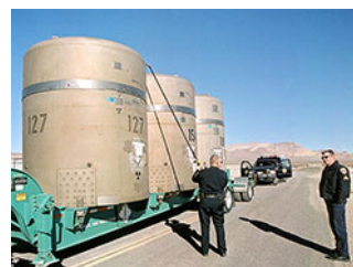
Transportbehälter für transuranhaltigen Atommüll in den USA.
